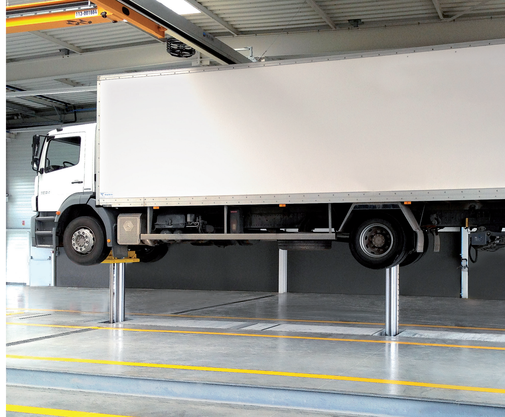
Abbildung: Zwei-Stempel-Hebebühne Tragfähigkeit: 16.000 kg pro Hubeinheit.
