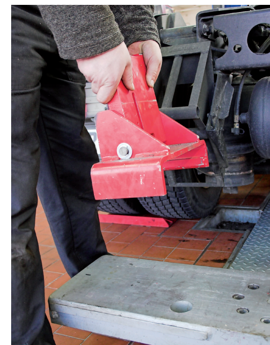
Auswechselbares Aufnahme-Schieber-System zum Anheben verschiedener Fahrzeugtypen.
