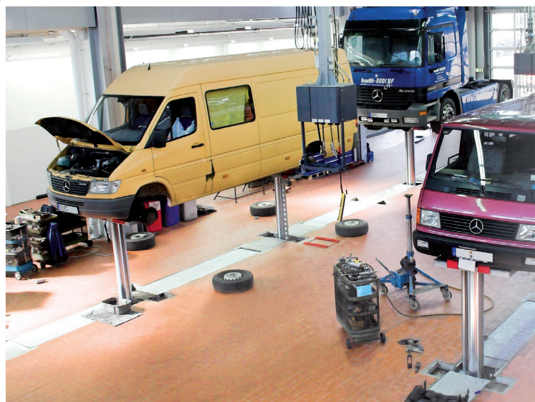
Vier-Stempel-Hebebühne HVH, die als 2 Zwei-Stempel-Hebebühne HVZ genutzt wird.
